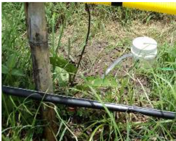
Figura 2: sistema de gotejamento automatizado acionado por sensor de umidade
