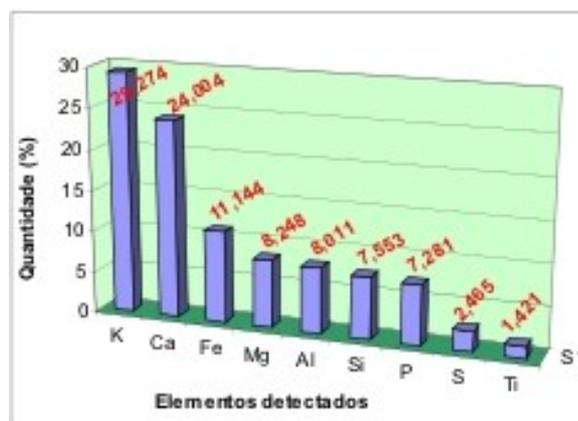
**Figura 4** – Histograma dos elementos detectados por XRF para o resíduo de cinza de caldeira – maiores concentrações.
