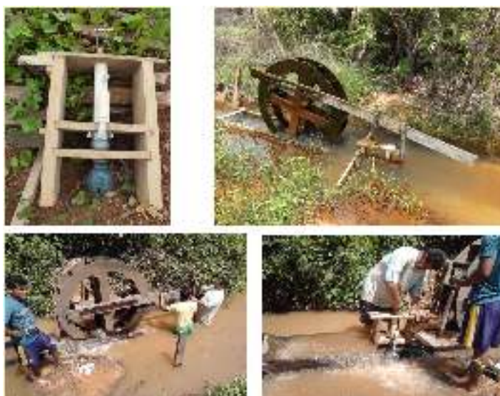
Figura 01 – Instalação e componentes da roda d'água acionada pela correnteza do igarapé no Campus Rural de Marabá.
