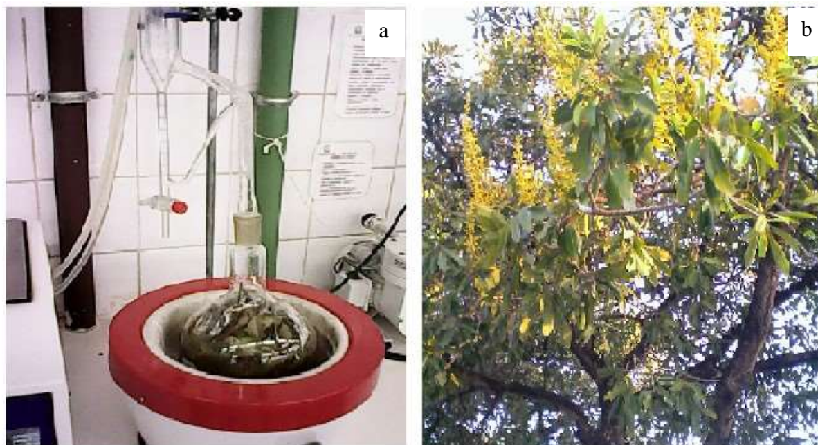
Figura 1: Aparelho clevenger utilizado para extração do óleo de cambará (a) e V. divergens (b).
